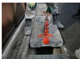
騒音発生を抑えた側溝蓋の開発 (実験ケースはゴム支承のデザイン/レイアウトの差)
