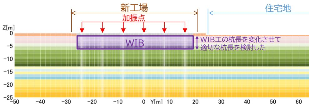
対象地の地盤をモデル化して、対策無しの場合の振動解析を行い、新工場から住宅地への振動影響を予測した。新工場では、12.5～50Hzの振動が卓越して発生すると予想され、同周波数の振動に対応したWIB工を設計した。対策有りの解析モデルでは、新工場の直下にWIB工を適用し、その減振効果を予測した。またWIB工の杭長を変化させて、適切な杭長を検討した。
